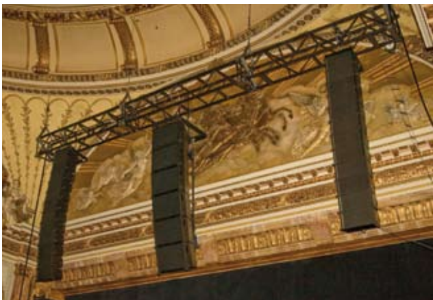
Zwei Bananen aus jeweils zwölf Cohedra-Compact-CDR-108-C wurden links und rechts geflogen
